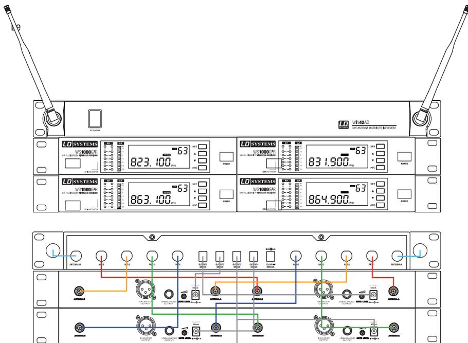
splitter antenne LDWIN42AD (optionnel) peut gérer jusqu'à 4 récepteurs monocanaux LDWS1000G2R ou jusqu'à 4 récepteurs double canal LDWS1000G2R2.
