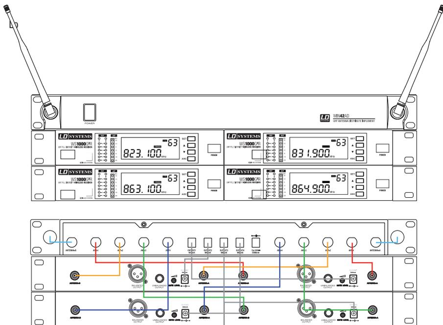
splitter d'antenna LDWIN42AD (optional) può gestire fino a 4 ricevitori singoli LDWS1000G2R o 4 ricevitori doppi LDWS1000G2R.
