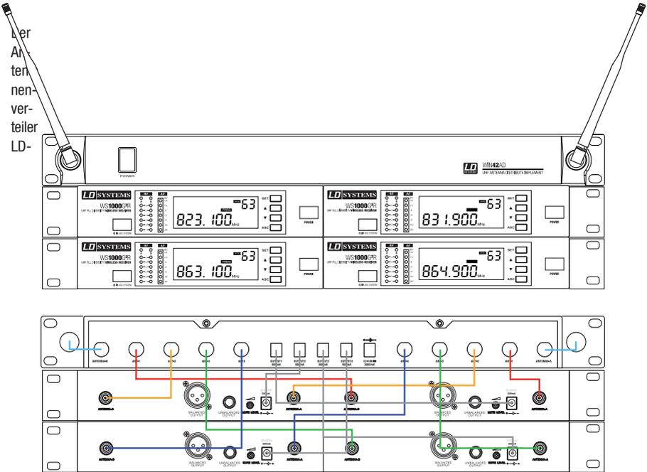
WIN42AD (optional) bietet Anschlussmöglichkeiten für bis zu 4 LDWS1000G2R Einzelempfänger oder 4 LDWS1000G2R Doppelpempfänger.
