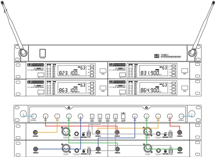
splitter de antena LDWIN42AD (opcional) puede conectarse hasta a 4 receptores simples LDWS1000G2R o hasta a 4 LDWS1000G2R receptores dobles.
