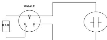
Microfono a cuffia, Lavalier o per strumento a fiato a bassa sensibilità. Una resistenza da 2,2 kOhm saldata tra i pin 2 e 3 aumenta il guadagno.
