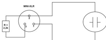
Serre-tête, micro cravate ou micro pour vents à bas niveau de sortie Souder une résistance de 2,2 kohms entre les points 2 et 3 augmente le gain.
