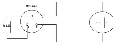
Headset, Lavalier- oder Blasinstrumentenmikrofon mit niedrigem Ausgangspegel Der Signalpegel lässt sich anheben, indem man zwischen Pin 2 und 3 einen Widerstand (2,2 kOhm) einlötet.
