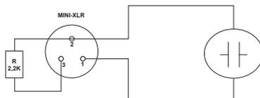
Micrófono de diadema, Lavalier o de instrumento de viento con salida de baja sensibilidad. Una resistencia de 2K2 soldada entre los pines 2 y 3 aumenta la ganancia.
