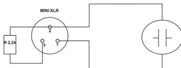
Mikrofon o niskiej mocy nagłowny, przypinany lub do instrumentów dętych. Rezystor 2,2 kOhm przylutowany na styku 2 i 3 zwiększa wzmocnienie.
