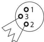
L'impiego di una resistenza terminale (terminazione) riduce le interferenze ed altri problemi relativi alla trasmissione di segnale. È sempre consigliabile inserire un modulo terminale DMX (resistenza 120 Ohm, 1/4 W) tra il polo 2 (DMX-) ed il polo 3 (DMX+) dell'ultimo apparecchio della catena.
