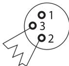
Die Verwendung eines Abschlusswiderstands (Terminierung) reduziert Interferenzen und andere Probleme bei der Signalübertragung. Es ist immer ratsam, ein DMX-Abschlussmodul (Widerstand 120 Ohm, 1/4 W) zwischen Pol 2 (DMX-) und Pol 3 (DMX+) des letzten Geräts in der Kette einzufügen.
