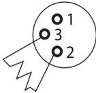
L'utilisation d'une résistance de terminaison ("bouchon") réduit les interférences et autres problèmes lors du transport du signal de pilotage. Il est toujours opportun d'implanter dans le connecteur du dernier appareil de la chaîne DMX un module de terminaison, utilisant une résistance de 120 Ohms, 1/4 W entre les points 2 (DMX-) et 3 (DMX+).
