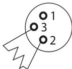
Una terminación reduce los problemas de transmisión de la señal y las interferencias. Se recomienda conectar un terminador DMX, (resistencia de 120 ohmios y 1/4 W) entre el pin 2 (DMX-) y el pin 3 (DMX+) del último equipo de la cadena.
