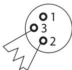
Zastosowanie terminatora zmniejsza zakłócenia i inne problemy przy transmisji sygnału. Zawsze wskazane jest wstawienie modułu zakończeniowego DMX (opór 120 omów, 1/4 W) między stykiem 2 (DMX-) a stykiem 3 (DMX+) ostatniego urządzenia w szeregu.
